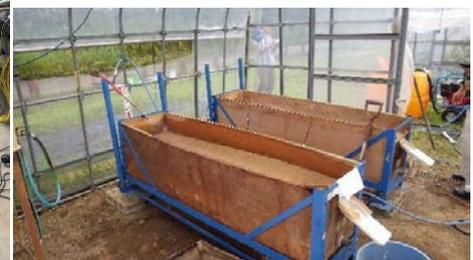
図3 石灰系改良土の表面流出試験
